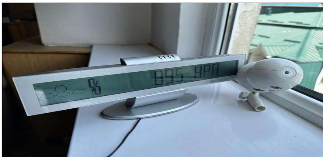
Рис. 1. Метеостанция «Цифровой погодный центр с бегущей строкой 02977» и измерителем интенсивности UV лучей «RST 02871».
