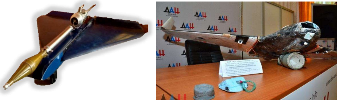
Рис. 2. Кустарно изготовленный БПЛА с выстрелом к РПГ (слева) и коммерческий БПЛА китайского производства SM-2 с кумулятивным зарядом КЗ-6 весом 3,5 кг (справа) (Украина).
