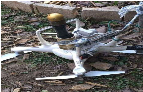
Рис. 5. Коммерческий китайский БПЛА «Фантом», использовавшийся для сброса противопехотной бомбы на основе выстрела автоматического гранатомета (САР).
