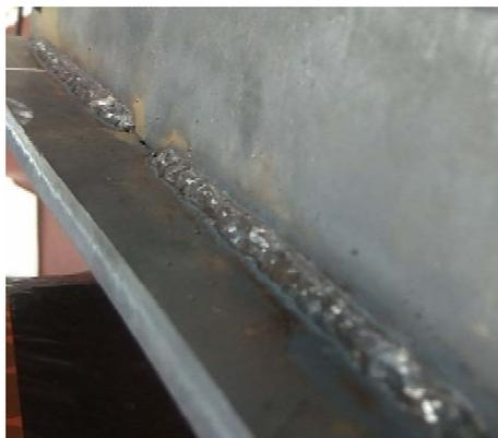
Рис. 2. Обратный валик сварного шва.
