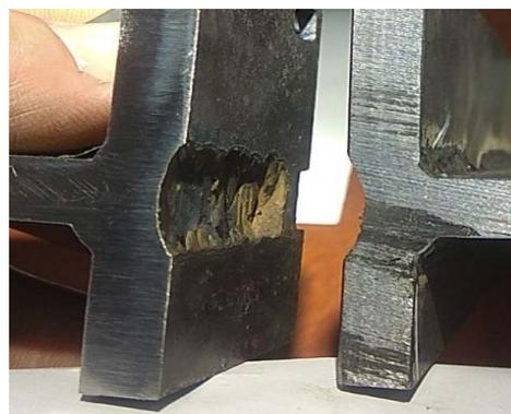
Рис. 3. Шлиф сварного шва, толщина сваренных деталей 8 мм.
