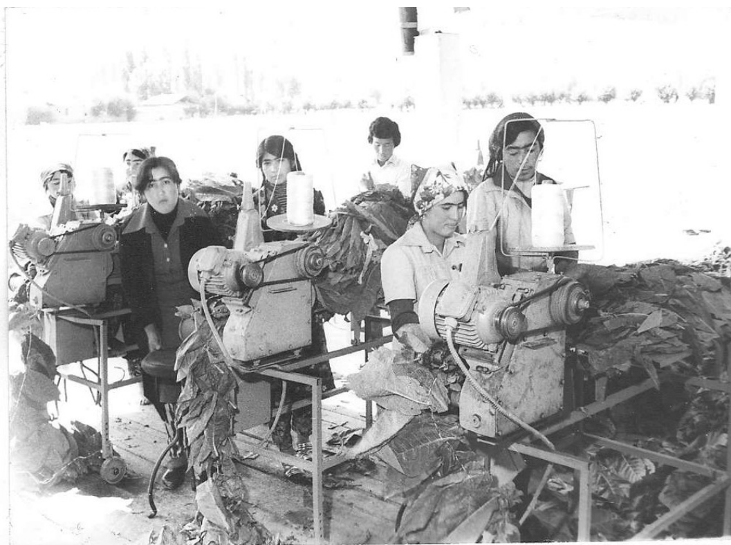
Рис. 3. Машинное закрепление листьев табака на шнуры для сушки.
