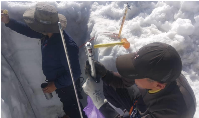
Рис. 3. Измерение плотности снега с помощью весов Pesola.
