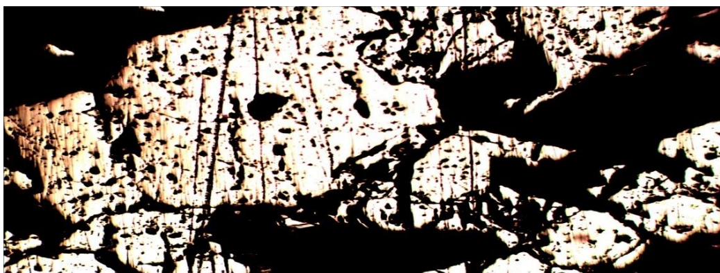
Рис. 4. Зерна арсенопирита. Ув.100, полированный шлиф.
