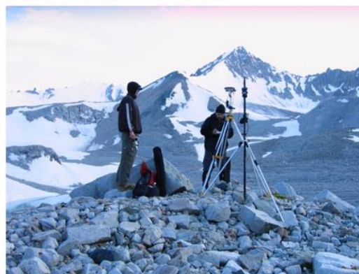
Рис. 6. Монтаж автоматических метеостанций и навигационных приборов GPS.
