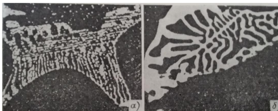
Рис. 2. Микроструктура быстрорежущей стали Р6М5 после проведения процесса отжига при 1160(а) и 1180 °С (б). [x800].
