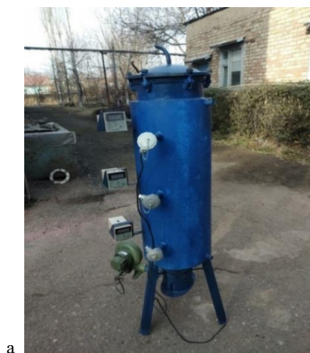
Рис. 1. Общий вид усовершенствованной пиролизной установки:
