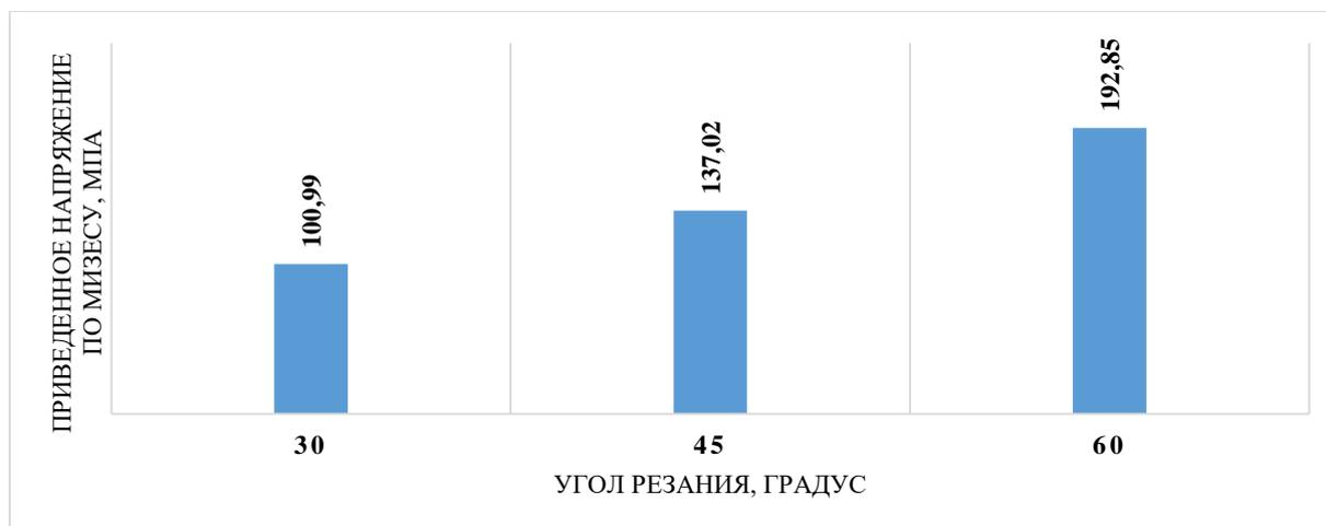
**Рис. 7.** Изменение максимального приведенного напряжения по Мизесу в режущем элементе в зависимости от угла резания почвы.
