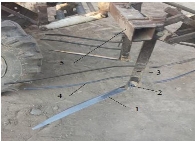
**Рис. 1.** Срезающее устройство фасолекосилки: 1 – режущий элемент (плоскорез), 2 – долото, 3 – стойка, 4 – направляющие усики, 5 – балка.
