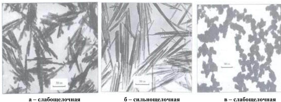
Рис. 1. Микрофотография частиц, полученных окислением: а) \alpha -FeOOH; б) \alpha -FeOOH; в) \text{Fe}_3\text{O}_4 .
