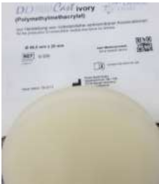
Рис. 1. Стандартная заготовка из полиметилметакрилата (моноблок).
