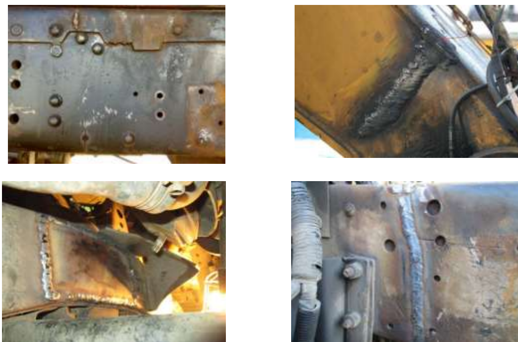
Рис. 5. Дефекты на рамах карьерных самосвалов и их результаты их восстановления.
