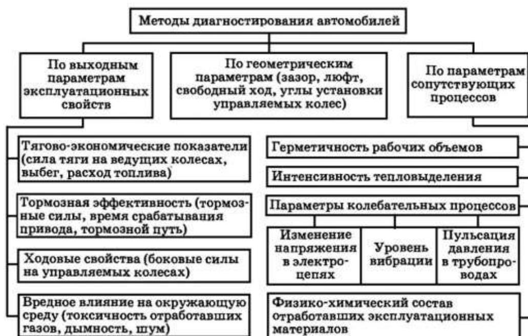
Рис. 2. Классификация методов диагностирования ТС (автомобилей).
