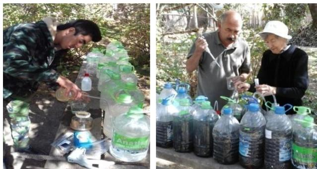
**Рис. 4.** Концентрирование урана из вод на активированном угле в полевых условиях Фото С.М. Саидова
