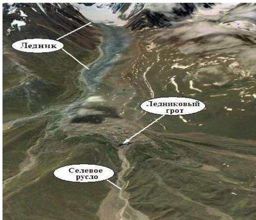
Рис. 2. Ледник и ледниковый грот, из которого вырвалась вода, явившаяся источником водной составляющей грязекаменного селя в бассейне р. Сурхоб в 2017 г. Селевое русло в верхней части селеопасного левого притока р. Сурхоб.
