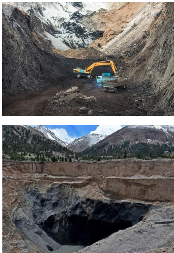
Рис. 2. При добыче угля на месторождении Кара-Киче карьеры подвержены ежегодно затоплению водой
