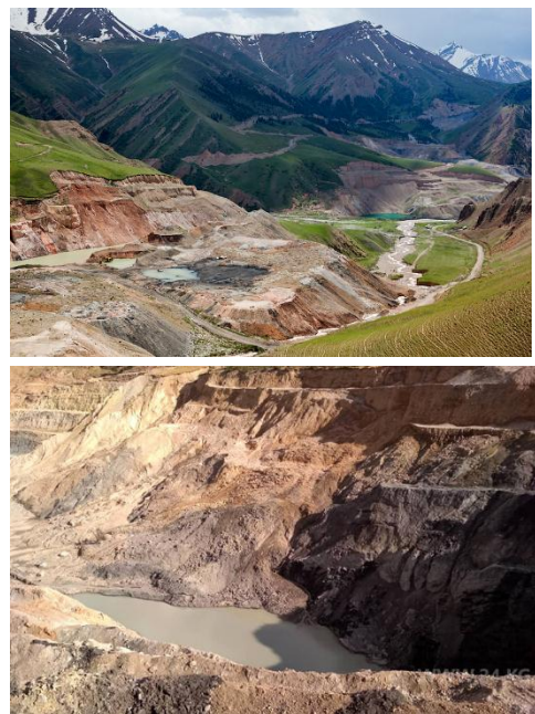
Рис. 3. Образование водных георисков на месторождении Кара-Кече
