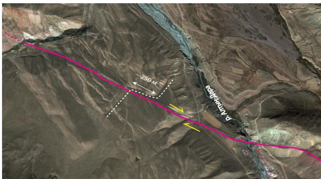
Рис. 8. Космический снимок Bing, на котором видна смещенная поверхность по правостороннему сдвигу в долине реки Алтын-Дара.
