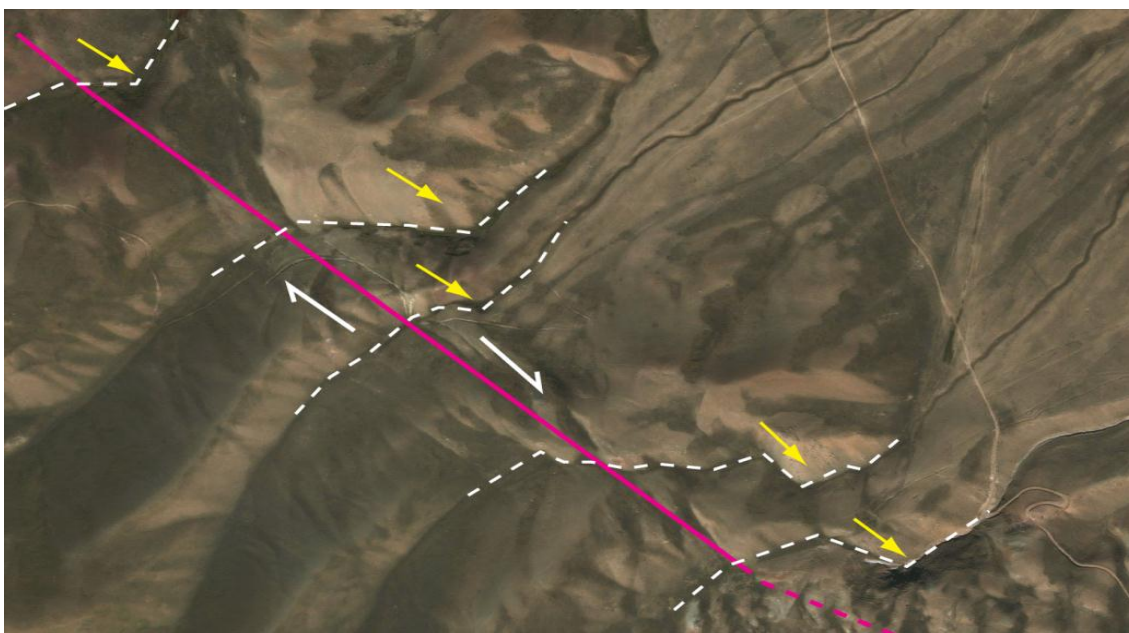
Рис. 7. Смещения сухих долин и водораздельных гряд по Арам-Кунгейскому правостороннему сдвигу.
