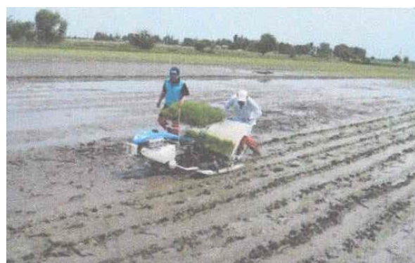
Рис. 6. Укладка кассет или полос (60x30 см) с рассадой для механизированной посадки в поле.
