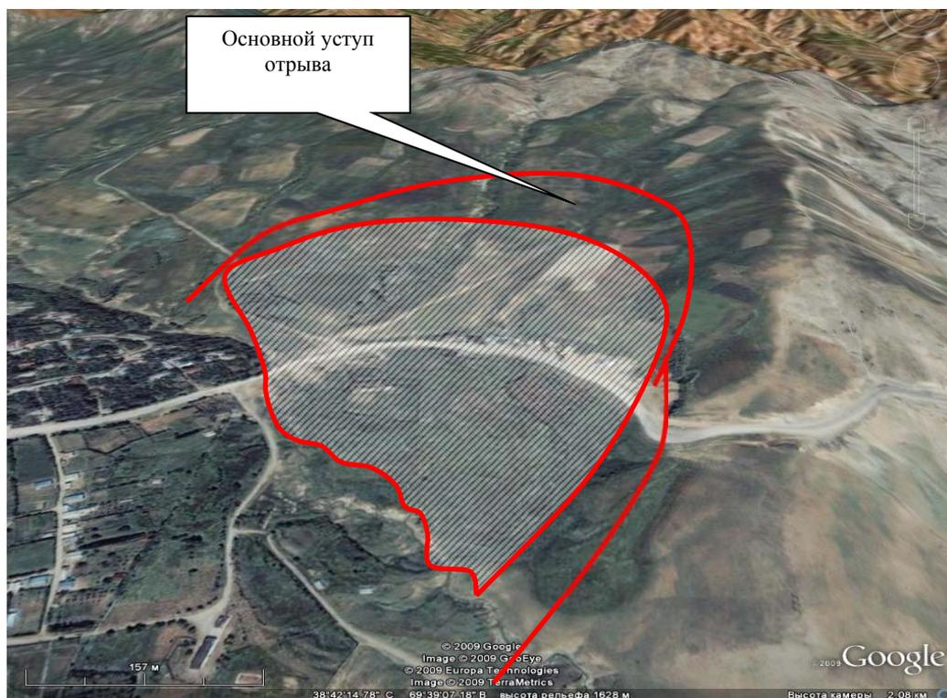
По предварительным расчетам площадь оползневого массива на 59 по 64 км составляет более 340 тыс. м<sup>2</sup> (рис. 6). Расстояние между языком и головной частью 410-450 м, протяжённость между бортами оползня составляет около 4 км, наиболее подвижная часть фиксируется на протяжении 700-760 м. Язык оползня находится в пойме реки Иляк. Глубинное
