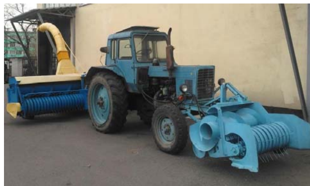
Рис. 1. Общий вид опытного образца широкозахватного подборщика-измельчителя кормов ПИК-3,0.
