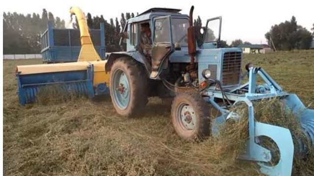
Рис. 2. Подбор сена с прокоса. Фрагмент работы опытного образца широкозахватного подборщика-измельчителя кормов.
