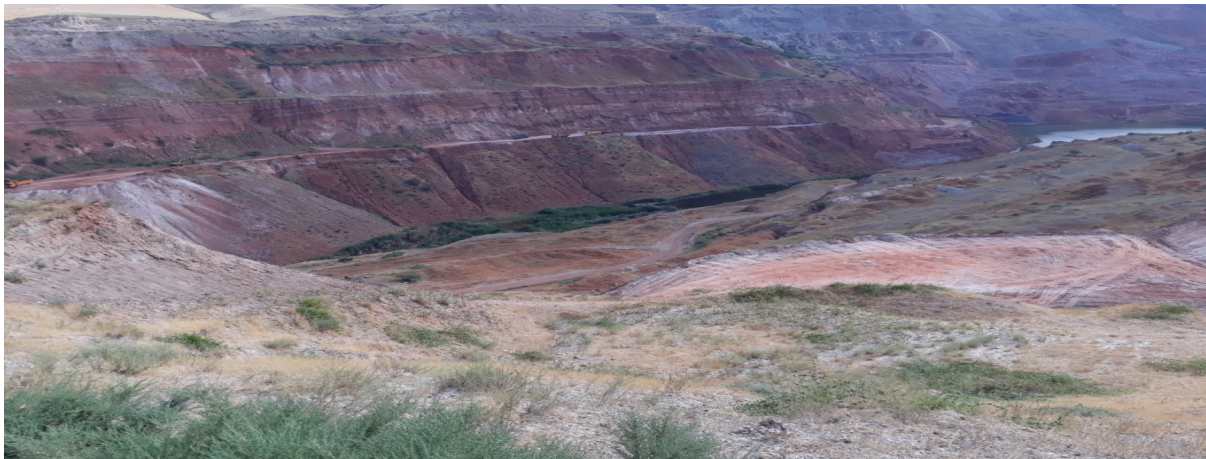
Рис. 2. Уступы разреза вскрышных горных работ, требующие соблюдения нормативных углов откоса бортов карьера для недопущения образования оползней и учета возможности защиты от обводнений подземными водами Алмалыкского месторождения углей (Фото Туркбаева П.Б. 10. 08. 2017г.).
