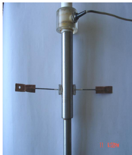
Рис.3 Схема и снимок рабочего участка стэнда с диффузором
