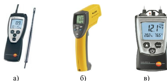
Рис.2. Приборы, использованные при натурных измерениях: а) testo 425 термометр-анемометр, б) инфракрасный бесконтактный термометр Fluke 68, в) testo 606-2 для измерения температуры и влажности воздуха, влажности материала
