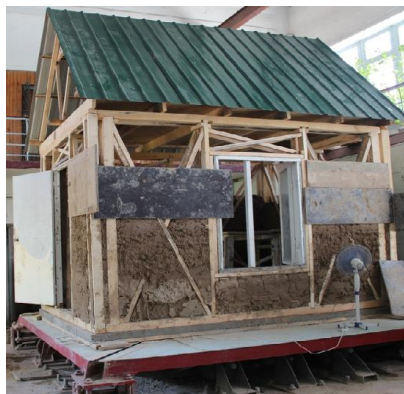
1-Сүрөт. «Сынч» түрүндөгү үйдүн моделинде көрсөтүлгөн байланыштар
