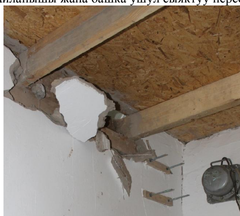
3-Сүрөт. «Сынч» түрүндөгү үйдүн моделинин эксперименттен кийинки учуру
