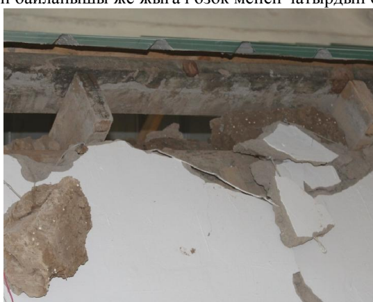
3-Сүрөт. «Сынч» түрүндөгү үйдүн моделинин эксперименттен кийинки учуру
