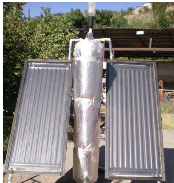
Рис. 1. Общий вид солнечной водонагревательной установки
