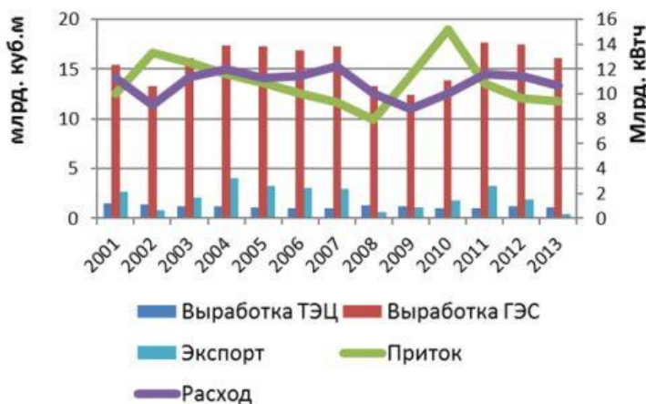
Динамика притока и расхода воды Токтогульского водохранилища, соответственно, выработки и экспорта электроэнергии за период 2001-2013 гг.
