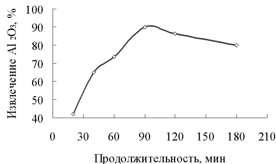
Рис. 4. Зависимость извлечения глинозема от продолжительности
