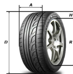
D - Диаметр шины, R - Диаметр диска, H - Профиль шины, A - Ширина протектора шины
