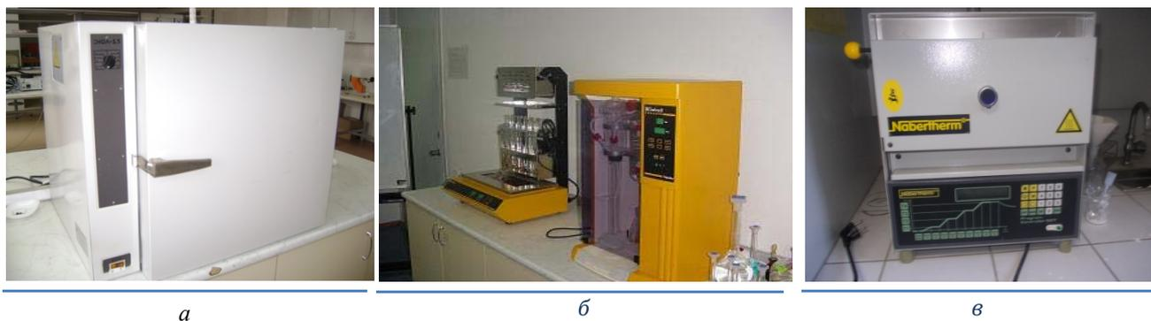
Рис. 2 а -Термостат марки СНОЛ -3,5; б- Аппарат Кельдаля; в-Муфельная печь марки Nabertherm
