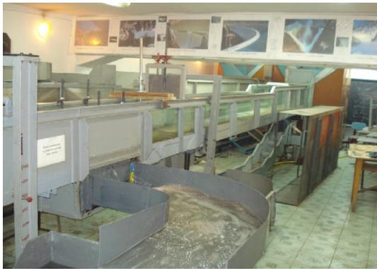
Рис. 2. ГЛЛ с моделью ВДКБТ в процессе исследований в лаборатории гидротехнических сооружений кафедры ГТСиВР КРСУ.
