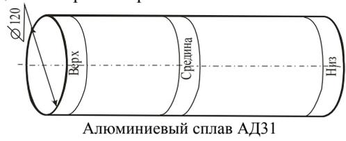
Рисунок 1 - Схема вырезки
