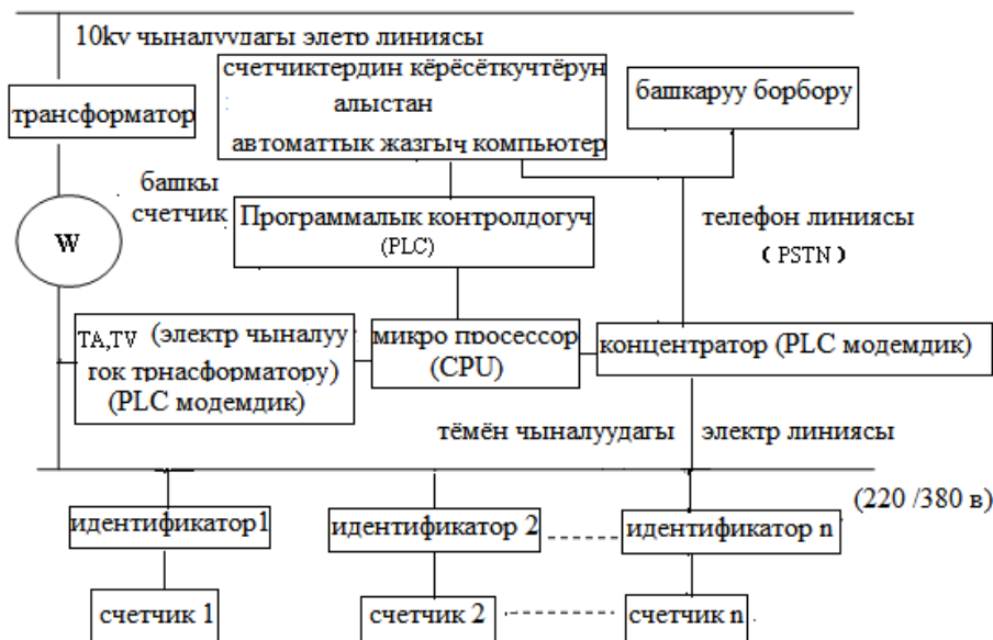
Чийме 1. Электр энергиясын эсептөөчү жана контролдоочу системасынын түзүлүшү
