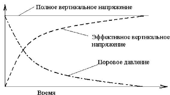
Рис 1. Изменение порового давления и эффективных напряжений в грунте
