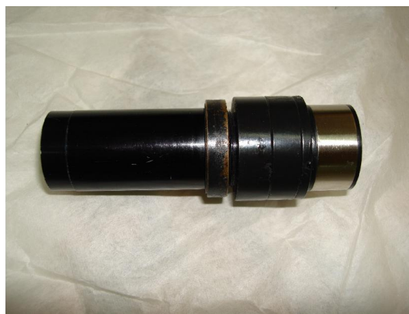
Рис.1. Общий вид оптической фотонасадки (7К X 90) для видеокамер и цифрового фотоаппарата.
