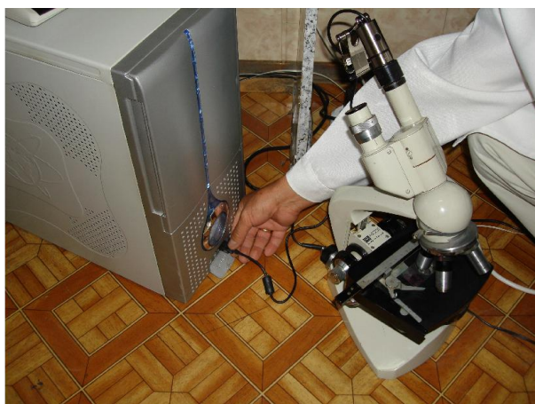
Рис.2. Световой микроскоп с видеокамерой, подсоединенной к компьютеру
