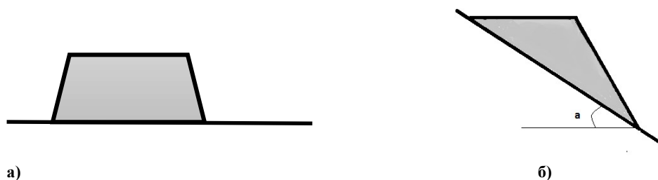
Рис. 2. Схемы размещения вскрышных пород: а) отвалы на горизонтальной поверхности, б) на наклонной поверхности.
