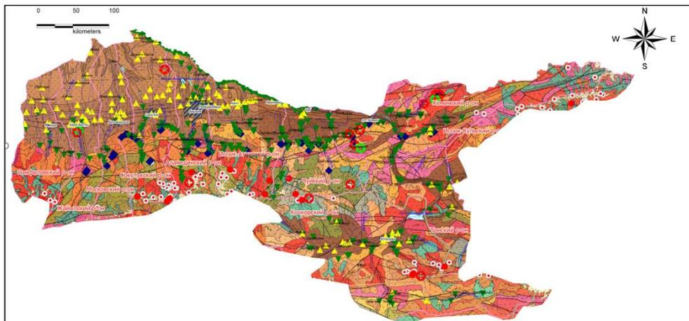
**Рис. 1.** Инженерно-геологическая карта закономерностей распространения и типизации георисков от прорывоопасных горных озер, оползней, селей, подтоплений, радиоактивных и токсичных хвостохранилищ и горных отвалов в бассейне реки Чу кыргызского Тянь-Шаня [4].
