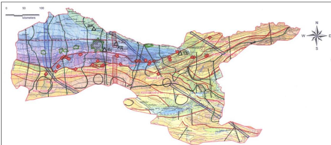
Рис. 2. Инженерно-геолого-геономическая карта на базе новейшей тектоники и мониторинга типизации георисков от оползней с объектами изысканий на 4-х объектах строительства различных по назначению сооружений в бассейне реки Чу кыргызского Тянь-Шаня [4].
