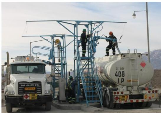
**Рис. 3.** Процесс заполнения емкости горюче-смазочными материалами.
