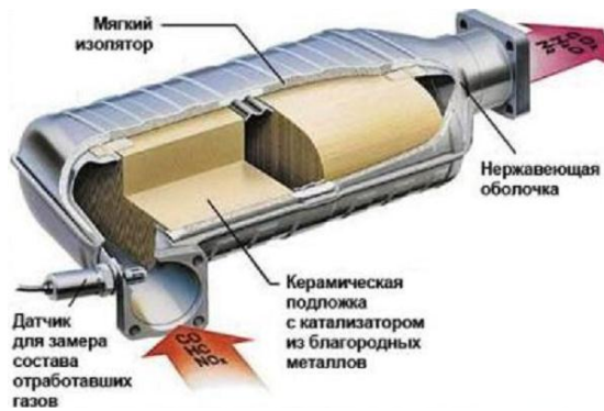
Рис. 3. Устройство каталитического нейтрализатора восстановительного принципа.
