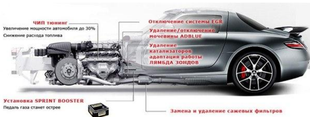
Рис. 2. Мероприятия по оптимизации рабочего процесса двигателя.
