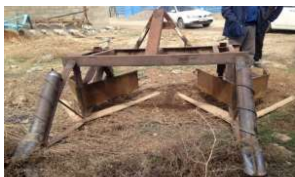
Рис. 3. Навесное устройство для раздельной уборки кустовых сортов фасоли.
