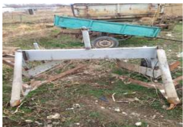
Рис. 1. Навесное устройство для раздельной уборки кустовых сортов фасоли.
