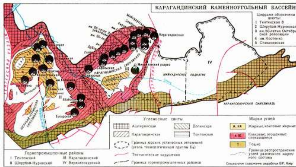
Рис. 1. Карта Карагандинского угольного бассейна с угленосными свитами и марками углей и районами горнопромышленных районов как основа для составления инженерно-геологической и экологической карты типизации георисков природного, техногенного, экологического и социально-биологического характера.
