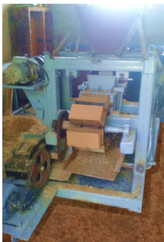
Рис. 1. Установка непрерывного формования глиняных кирпичей.
