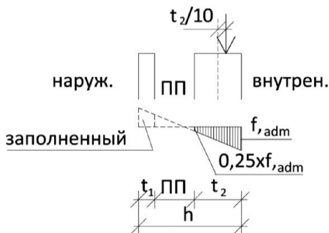
Рис. 3. Распределение напряжения в трехмерной стене с различной толщиной каркаса, нагруженной на одну сторону.
