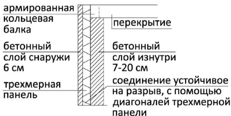
Рис. 2. Конструкция трехмерной стены, изготовленной на заводе из легкого бетона (сечение).
