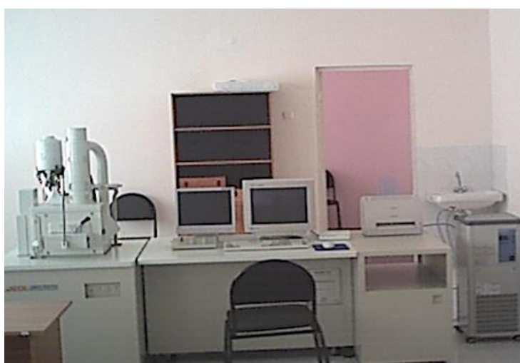
Рисунок 3. Внешний вид электронного микроскопа JSM 5910
