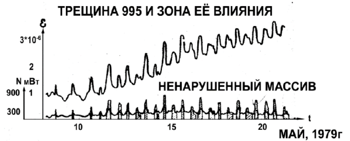
Рис. 2. Вибросмещения по трещине 995 и в ненарушенном массиве при работе гидроагрегатов [2].
