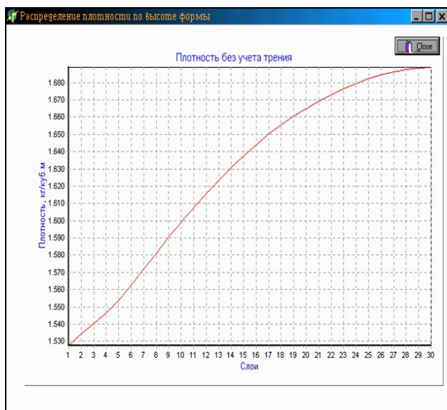
Рис. 6. Расчетные значения конечного распределения плотности по высоте формы (машина газоимпульсной формовки фирмы Georg Fisher DISA AG с размером опок 800 мм * 600 мм * 240 мм).
