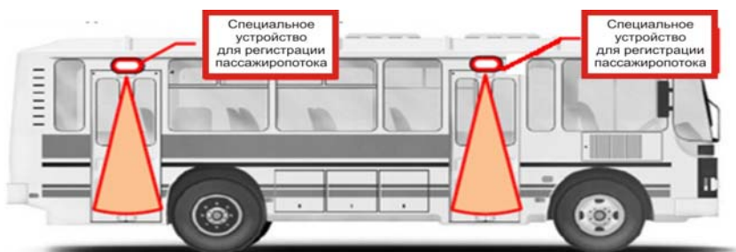
Рис. 3. Схема установки специального устройства на автобусе.
