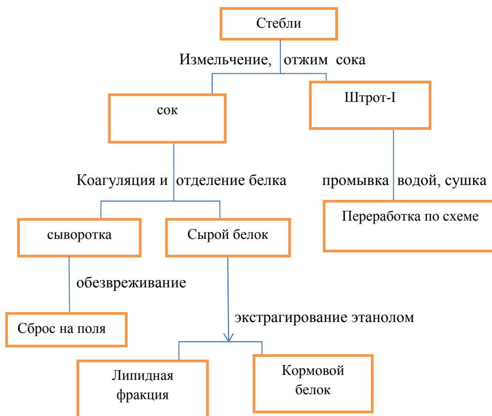
Рис.1 Принципиальная схема технологии первичной переработки свежесрезанных стеблей табака
