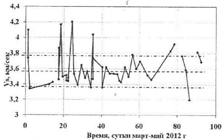
Рис. 3б. Вариация значений скорости поперечных волн V_s Кумторских взрывов за март-май 2012 г., распространенных в верхней части земной коры
