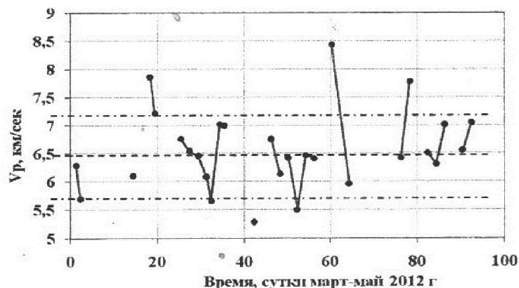
Рис. 4а. Вариация значений скорости продольных волн V_p Кумторских взрывов за март-май 2012 г., распространенных в нижней части земной коры
