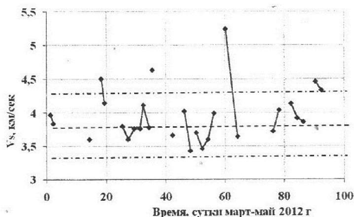
Рис. 4б. Вариация значений скорости поперечных волн V_s Кумторских взрывов за март-май 2012 г., распространенных в нижней части земной коры
