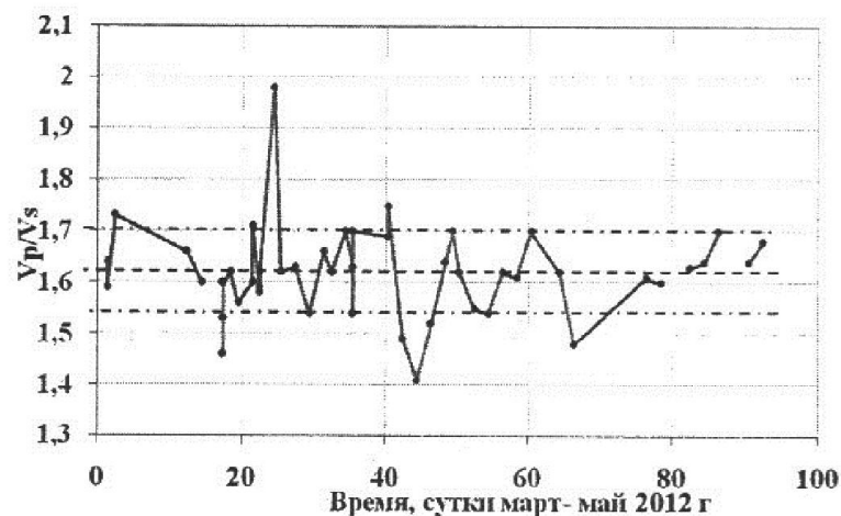
Рис. 3в. Вариация значений величины V_p/V_s Кумторских взрывов за март-май 2012 г., характеризующая верхнюю часть земной коры
